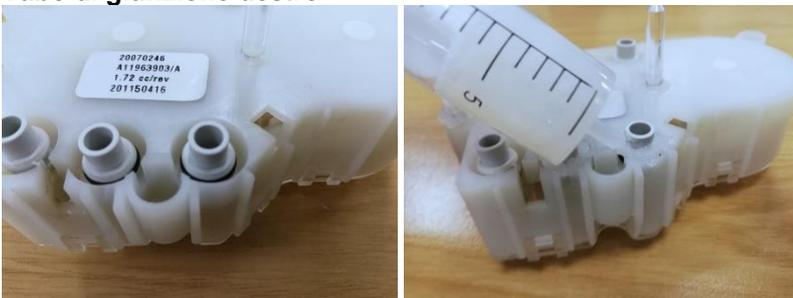
4. Inserire gli o-ring delle guide ottiche all'interno delle fessure nel cassetto del detersivo (vedere la foto di seguito):
